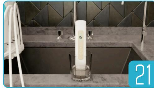
Entnehmen Sie ein Glas Wasser vom Reinwasserhahn. Messen Sie die Wasserqualität. Wiederholen Sie dies, bis das Messgerät einen Wert < 20 ppm zeigt.
